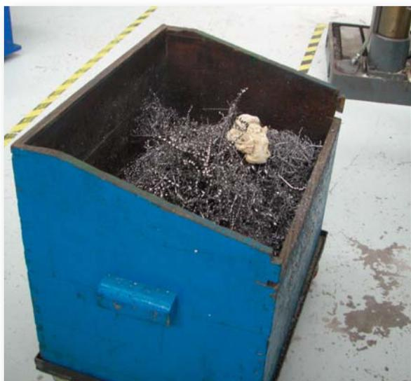
Figura nº48. Virutas metálicas contaminadas
