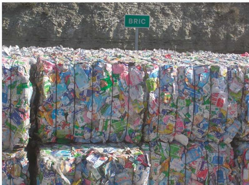
Figura nº33. Balas de envases de bricks recuperados después de su separación de planta de clasificación de envases
