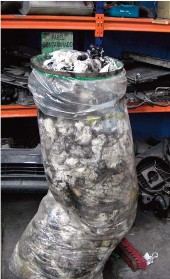
Figura nº11. Ejemplo de residuo peligroso: Papel contaminado de taller automoción
